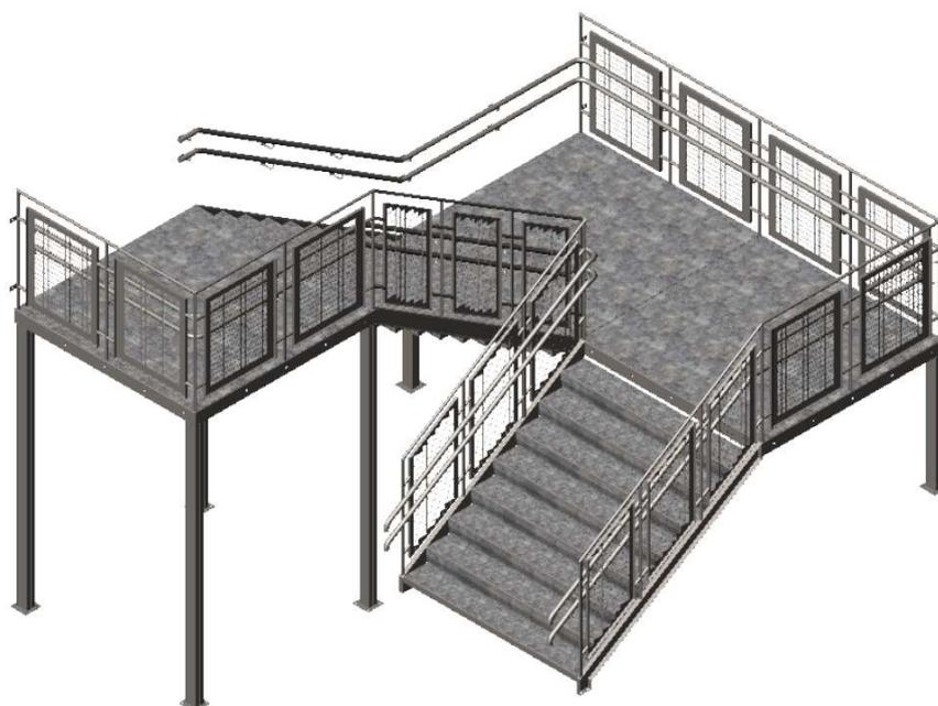
Desenho 07 – Forma construtiva da escada de saída de emergência.
